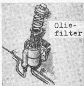
Fig. 17. — Indien de motor voorzien is van een oliefilter, is het wel dienstig na te gaan om de hoeveel kilometer dit gereinigd moet worden. Soms moet het filterelement verwisseld worden! Cl. V.A.B.
